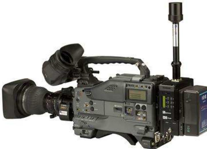
Figura 1 - Câmera portátil sem fio HD (acoplada ao módulo de RF e Antena)
