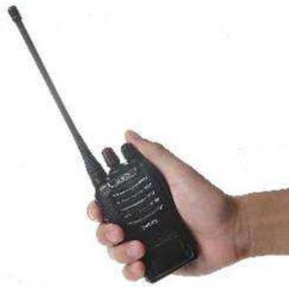
Figura 8 - Radiocomunicador portátil tipo HT
