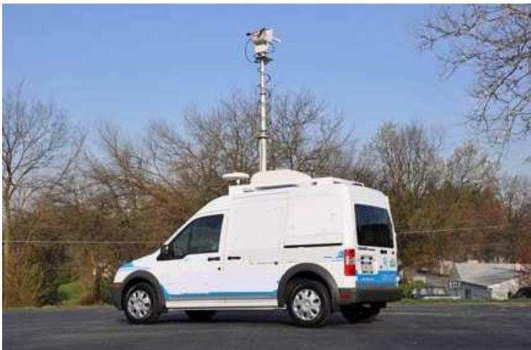
Figura 5 - Estação móvel do SARC – Reportagem Externa
