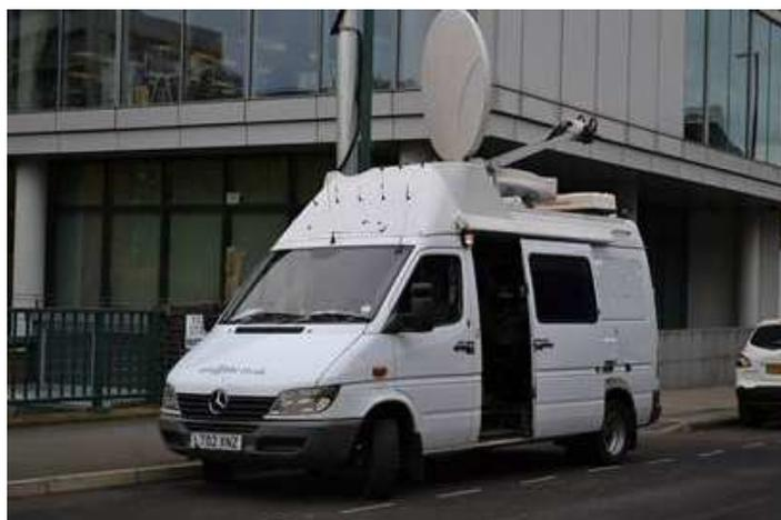
Figura 4 - Estação móvel de transmissão/recepção via satélite
